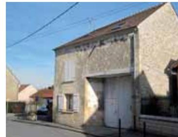
Les ouvertures sont disposées selon un certain ordonnancement. Les fenêtres sont plus hautes que larges. Leurs linteaux et appuis sont alignés horizontalement. Le comble est parfois éclairé par une ancienne lucarne engagée dans la maçonnerie.
