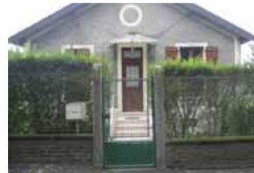
Les portes et portails sont encadrés de piles en pierre, en enduit ou en brique, présentant un profil droit de même hauteur que les murs.
