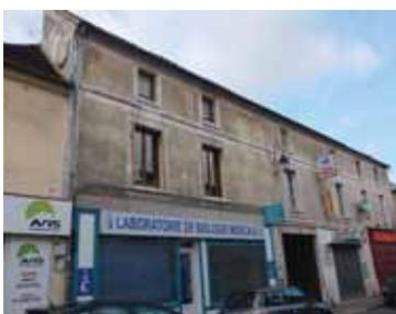
La tuile plate en terre cuite, la pierre et le moellon calcaire enduit constituent les matériaux de construction des petits immeubles de Viarmes. Les nombreuses modénatures tels que corniches, bandeaux, pilastres, modillons, sont en plâtre ou en pierre. Les encadrements de fenêtres sont parfois en pierre ou en moellon enduit.
