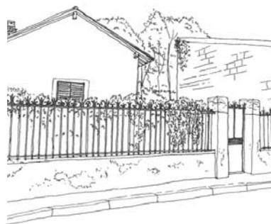
Clôture formée par un mur bahut en moellons enduits, surmonté d'une grille en fer forgé
