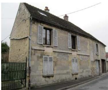
La tuile plate en terre cuite, le moellon calcaire enduit et la pierre de taille constituent les matériaux de construction des maisons de bourg. Les rares modénatures, tels que corniches, bandeaux, sont en plâtre. Les encadrements de fenêtre sont en moellon enduit, parfois en pierre. La pierre est au nu ou en saillie par rapport à l'enduit.
