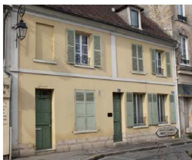
La tuile plate en terre cuite, le moellon calcaire enduit, parfois la pierre de taille en soubassement, constituent les matériaux de construction des maisons de village. Les rares modénatures tels que corniches, bandeaux sont en plâtre, rarement en pierre. Les encadrements de fenêtres sont en moellon enduit, parfois en pierre.
