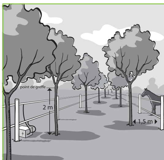
Protection contre les chevaux
